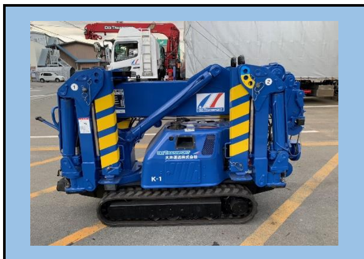
2.35t吊り カニクレーン
